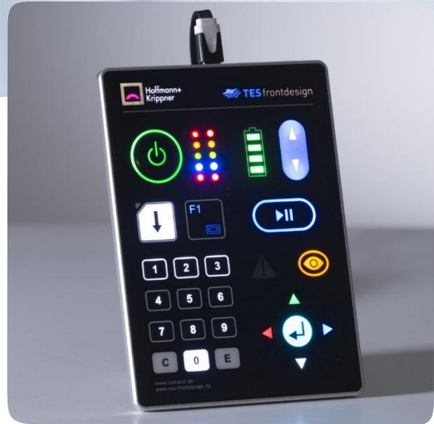
LED-Technik, kombiniert mit einem ausgeklügelten Aufbau, ermöglicht die Realisierung von beleuchteten Folientastaturen, die nur geringfügig dicker als die verbreitete EL-Beleuchtung sind.
