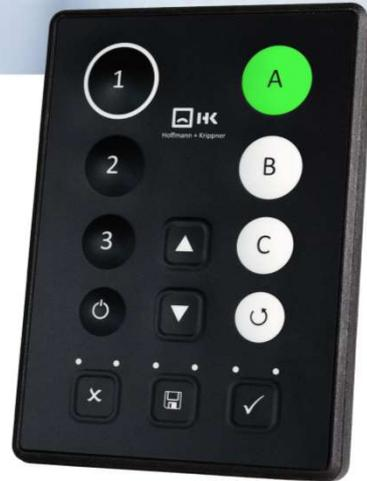
Tactile Key ermöglicht ein nachhaltiges Bedienkonzept. Der Systemaufbau bringt neue Features für kapazitive Tasten mit sich und erlaubt eine einfache Demontage der Elektronik von der Bedienfront (Reparatur, Recycling).
